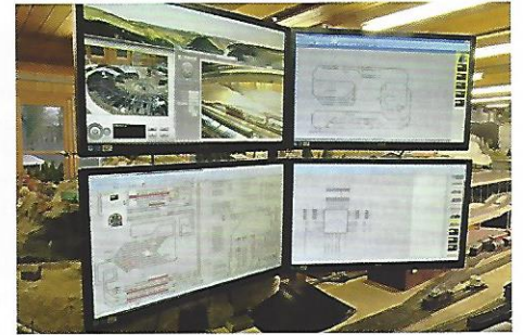
Vier Bildschirme mit Gleisplänen dienen der Steuerung der H0- und der H0m-Anlage mit Win-Digipet.
